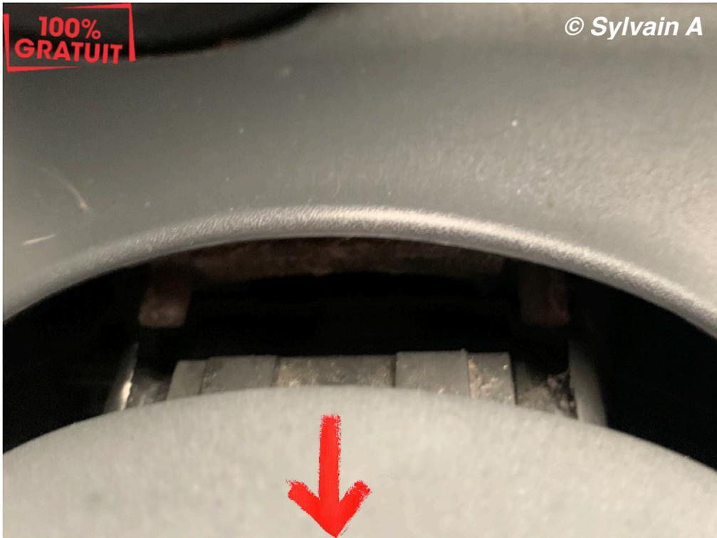
Basculez le volant vers le bas sans tirer sur les connecteurs. Rouge pour l'airbag et noir pour l'ESP, les palettes et le Klaxon.
