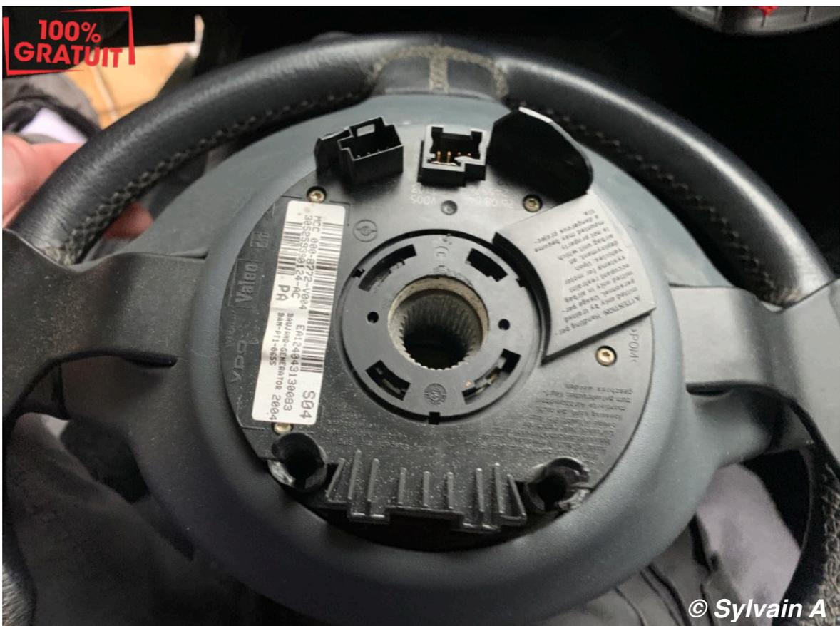
Ceux et celles qui ont un problème de palettes qui ne répondent plus ou fonctionnent une fois sur deux, pensez à **resserrer les fiches métalliques à l'aide d'une aiguille (protocole Mercedes)** sur les cosses mâles. Personnellement, ça m'a résolu le problème depuis plus d'un an.
