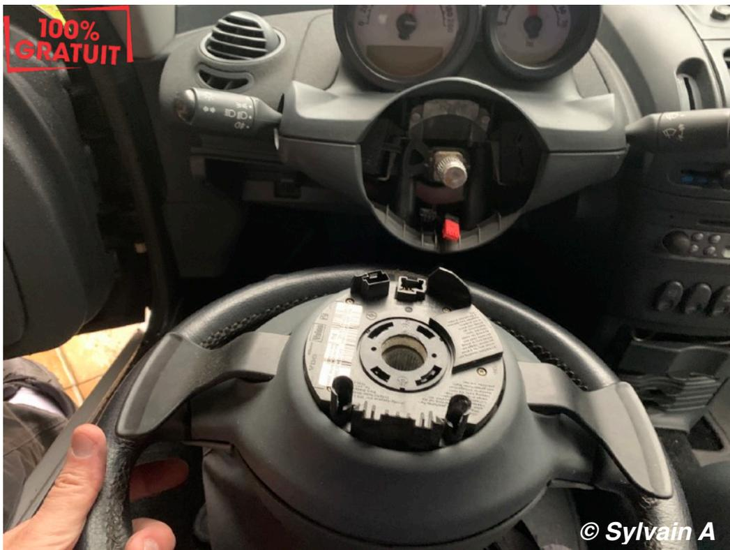
Pensez absolument à bloquer le capteur d'angle d'ESP, avec du scotch par exemple, une fois les fiches déconnectées. Il ne faut pas qu'il tourne au risque de dérégler le capteur et de devoir le faire régler chez Mercedes.
