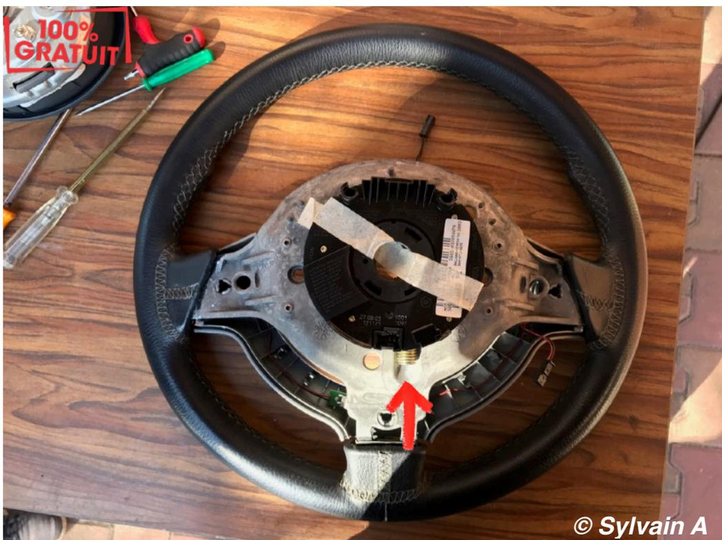
Voici une photo sans le cache, théoriquement le capteur d'angle est bloqué par la Vis qui maintient le volant.
