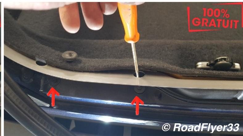
Votre body panel est maintenant partiellement libre. Il reste à débrancher vos feux arrière et vos feux de plaque. Pour cela, dégagez doucement vers l'arrière tout le body panel d'une 15aine de centimètres.
