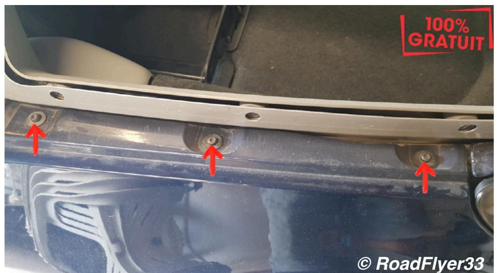
Retirez soigneusement sans le déchirer le joint de coffre arrière (pas sur le Cab évidemment ;-)). Puis desserrez les 4 vis Torx qui restent.
