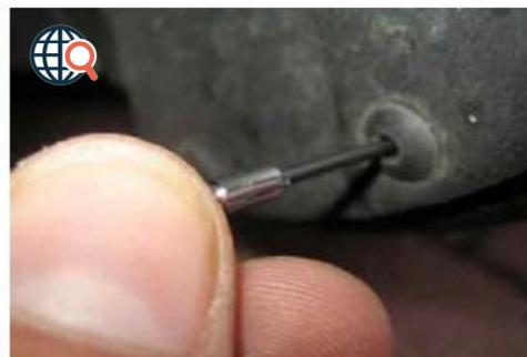
Vous pouvez tourner le volant du côté opposé à celui dont vous voulez changer l'ampoule pour faciliter l'accès. Dégagez le garde boue sur quelques centimètres afin de permettre le passage de la main. Libérez le bulbe de son logement depuis l'intérieur puis changez votre ampoule.
