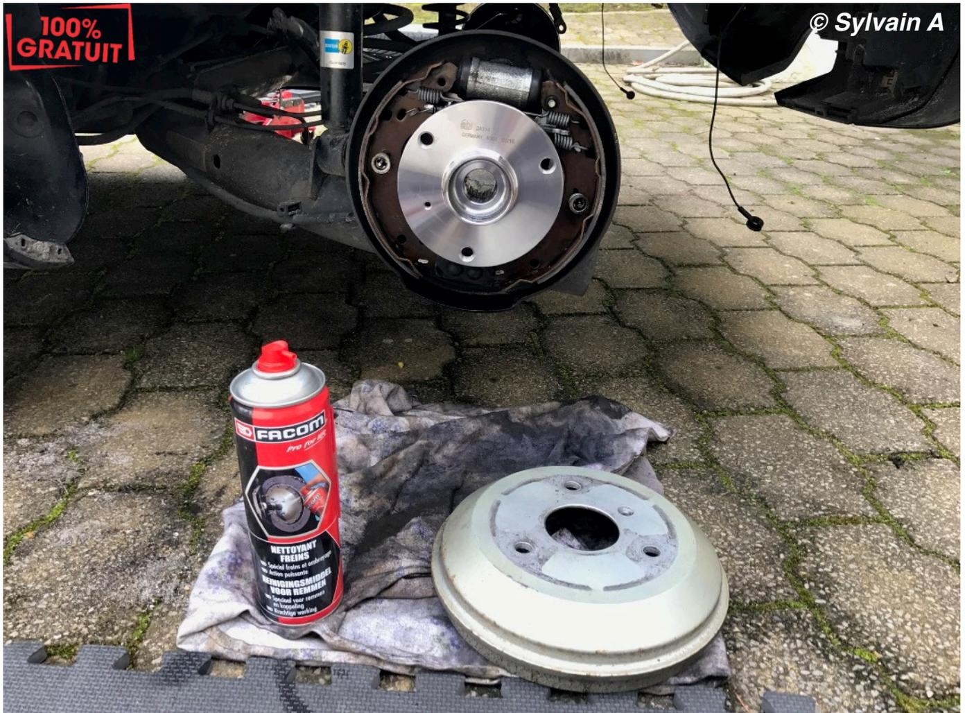
À ce stade, vous pouvez pulvériser du **nettoyant freins** pour retirer toutes les poussières accumulées et vérifier si le cylindre de frein ne fuit pas. Un simple nettoyage suffit parfois à dégripper le système. Vous pouvez vérifier le bon fonctionnement du frein à main également.
