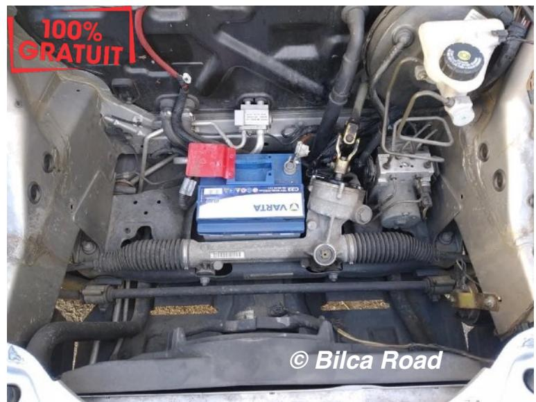
2- On retire les 2 vis de fixation de la crémaillère + celle du moteur de la DA.
