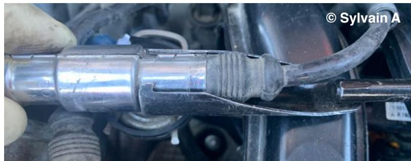
Une fois les bougies visibles, desserrez-les à l'aide d'un **cliquet muni de sa rallonge et d'une douille six pans de 16**.
