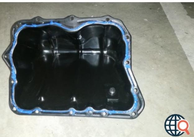
Vous disposerez la pâte à joint sur le nouveau carter ou sur le moteur comme suit et la laisserez sécher pendant environ 30min. Puis, vous pourrez garnir le reste du bord externe du carter avec de la pâte à joint juste au moment de le fixer. Ainsi, l'excédent de colle ne pénétrera pas dans le bloc moteur au moment du montage.
