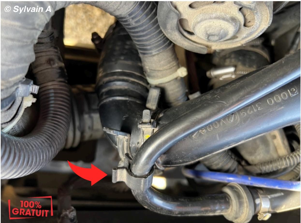
Dévissez les colliers de la tubulure d'admission au papillon et à l'échangeur.
