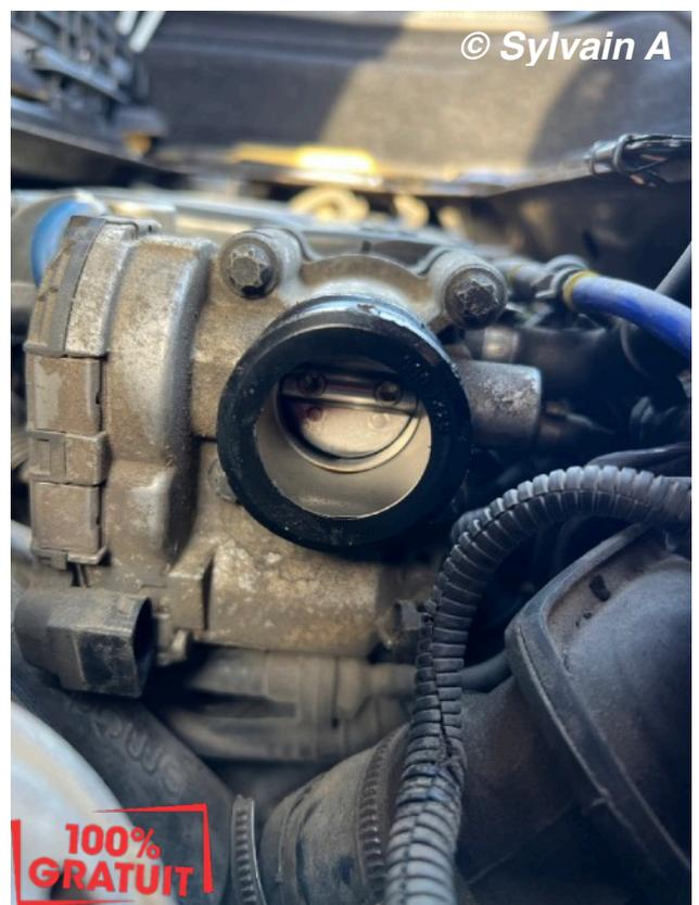
Dévissez les 4 vis du boîtier papillon avec une douille Torx de 10
