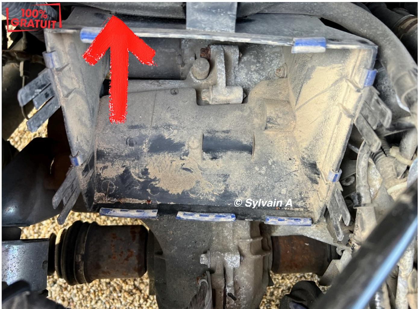
Pour éviter que les vibrations abîme l'intercooler, vous pouvez prendre des bouts de tuyau silicone que vous fendez et les emboîtés sur le support.
