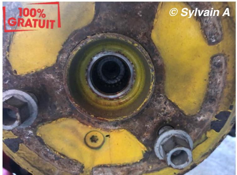
Enfin avec une barre de fer, induisez un mouvement transversal sur l'essieu avec la mobilité obtenue. Ainsi, vous pourrez sortir le cardan de son emplacement côté roue. Vous avez libéré une partie du roulement.
