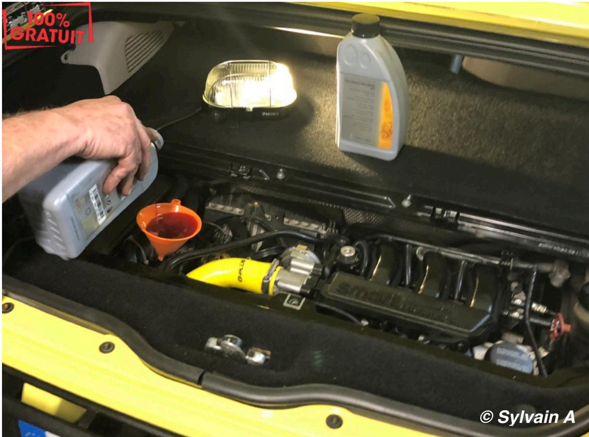
**C'est une vidange par débordement donc remplissez la boîte jusqu'à que l'huile coule par le trou de remplissage du haut**
