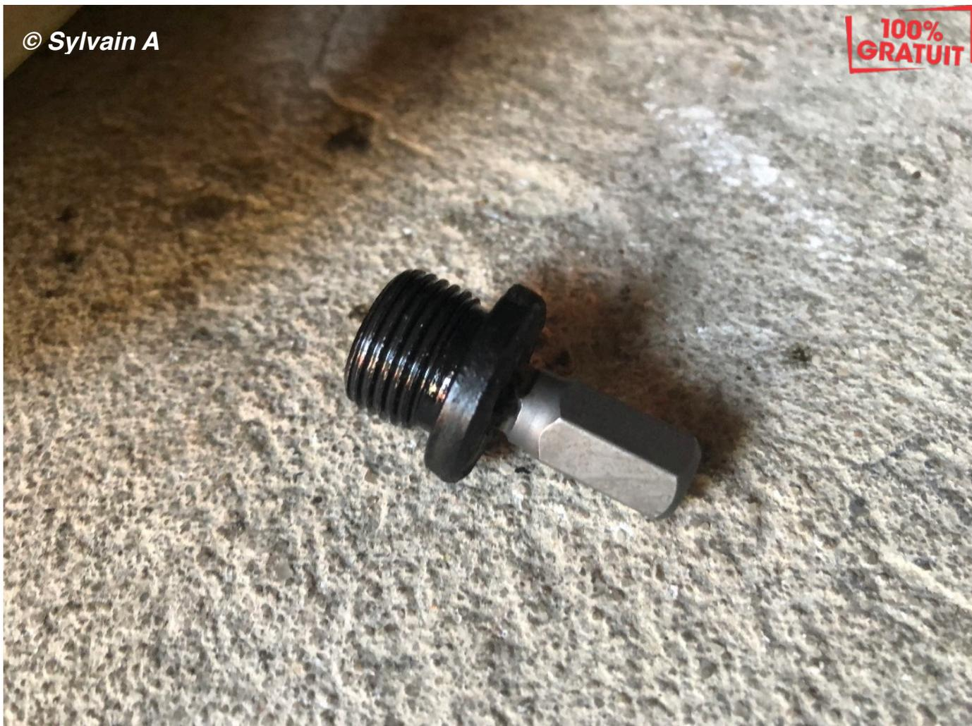
Repositionnez le **bouchon du dessous** (2) à sa place une fois les 1,4 L écoulés.
