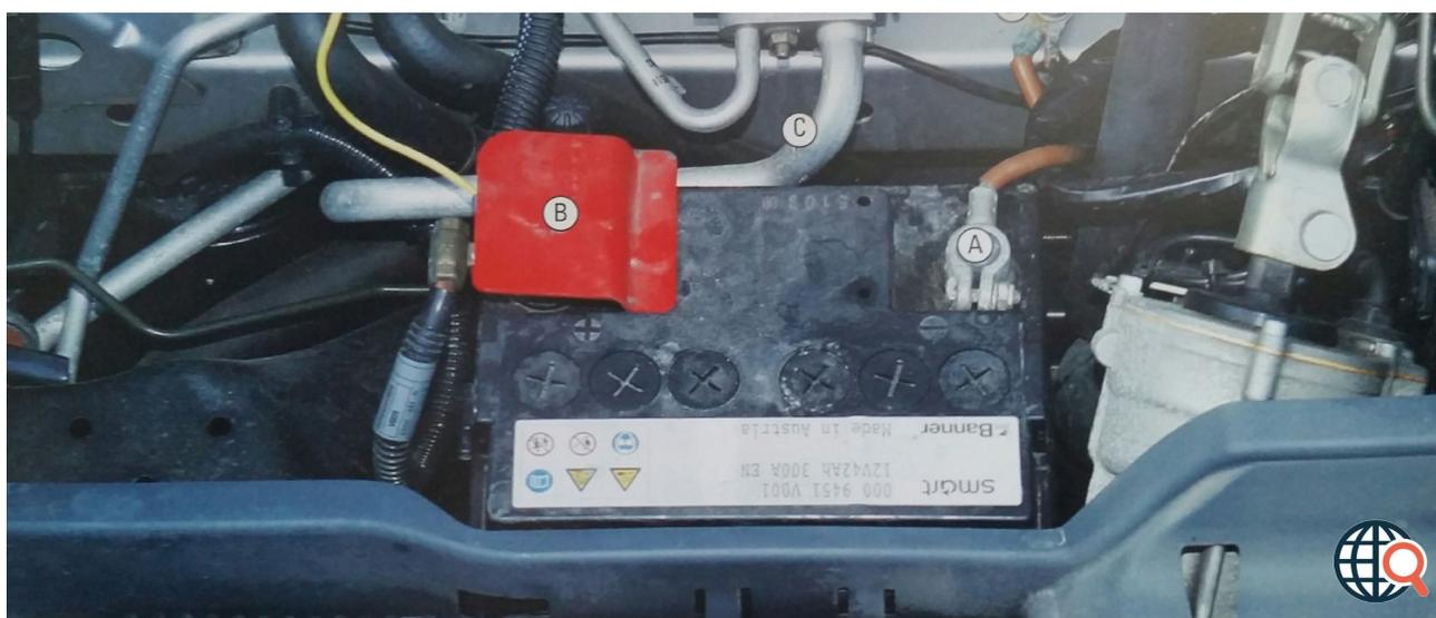
A l'aide d'une **douille** ou d'une **clé de 10**, desserrez et retirez toujours la cosse MOINS (A) avant.
