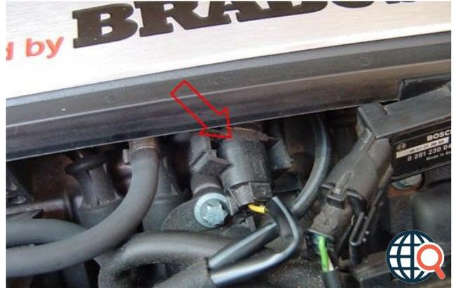
Ce capteur est monté sur les moteurs Smart 599cc et 698cc. Il mesure la température de l'air entrant dans le moteur. L'air froid est plus dense, nécessitant plus de carburant. L'air chaud n'est pas aussi dense que l'air froid, ce qui nécessite moins de carburant. Le calculateur moteur prend les mesures de ce capteur et compense les variations de la température de l'air pour maintenir un rapport air / carburant presque parfait.
