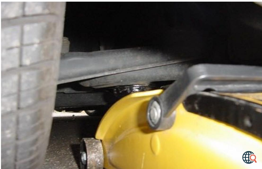
Au niveau du triangle de suspension pour lever l'avant.
