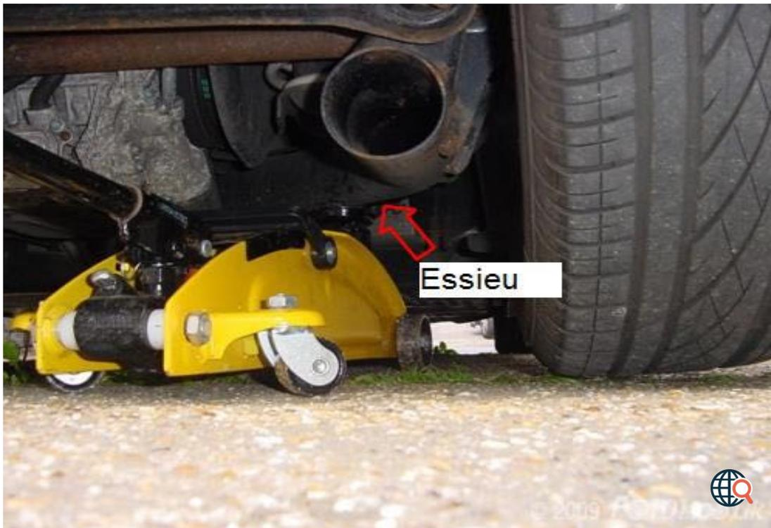
Au niveau de l'essieu arrière pour lever l'arrière du Road.
