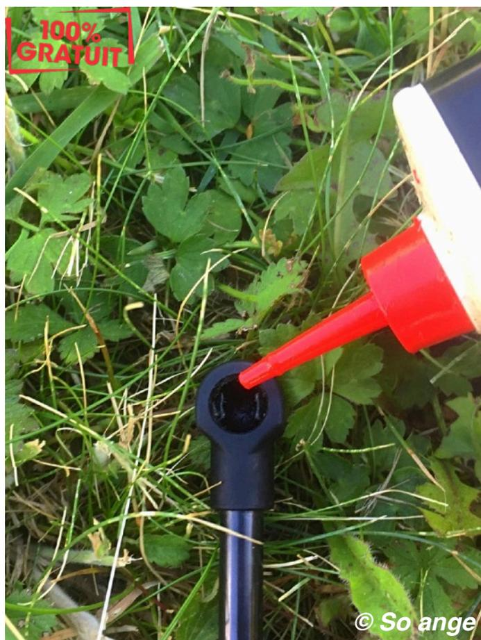
Poussez l'embout creux du vérin sur la rotule du bas jusqu'à entendre un "clic" de verrouillage du clips. Emboîtez ensuite l'embout du haut.
