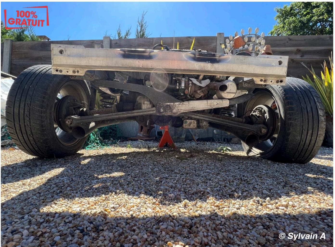
À l'aide d'une douille torx de 18 et d'une clé plate de 18, desserrez la barre stabilisatrice X.
